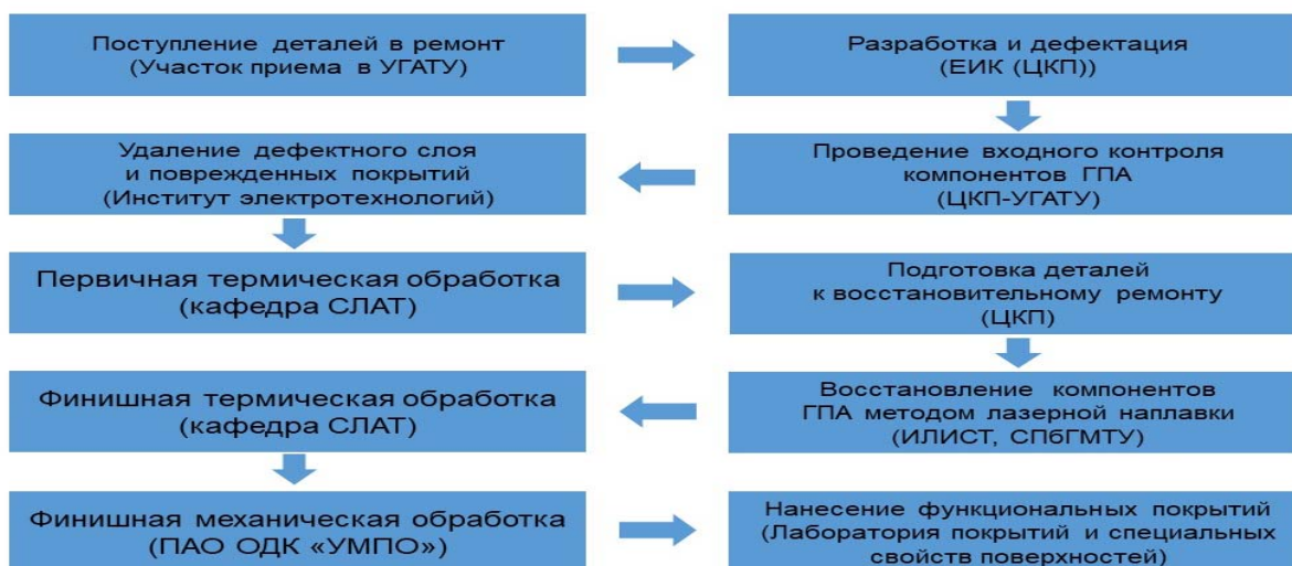
Рисунок 2. Алгоритм восстановления детали «лопатка турбины»
